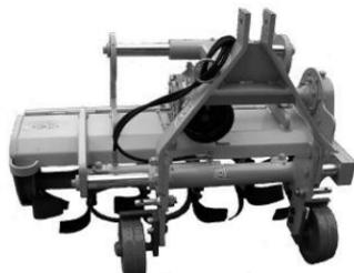
Fresatrice spostabile idraulicamente
