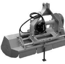
Trinciasementi spostabile idraulico
