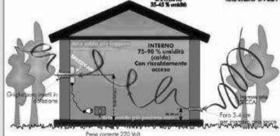
Per eliminare da tutte le camere l'aria umida, si consiglia (mentre la ventola SPEEDY-AIR è in funzione) di lasciare aperte tutte le porte interne. La ventola gira per due minuti, permettendo un ricambio d'aria senza buttare fuori il calore del riscaldamento ma solo l'umidità.
